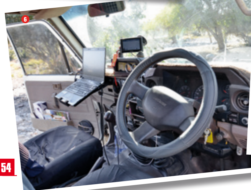
1 et 2) L'aménagement arrière du Toy réalisé par la famille Trastour elle-même. 3) Séance de découpage des panneaux intérieurs. 4) Pose du panneau solaire sur la galerie. 5) Des amis de la famille ont aussi donné un coup de main à la fabrication de l'aménagement intérieur. 6) La cabine du Toy est très bien équipée pour la navigation : GPS et PC portable. 7) L'intérieur des cloisons a aussi été exploité pour gagner du volume dans l'aménagement. 8) Une partie de l'installation électrique de Loongin.
